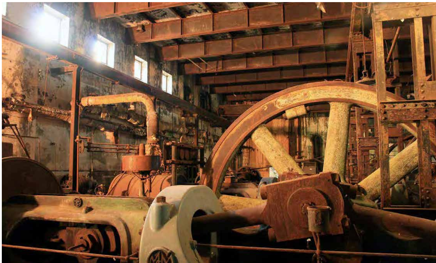
Sala de compresores de amoníaco, generadores de frío para las enormes cámaras que tenían capacidad para 18.000 toneladas de carne.
